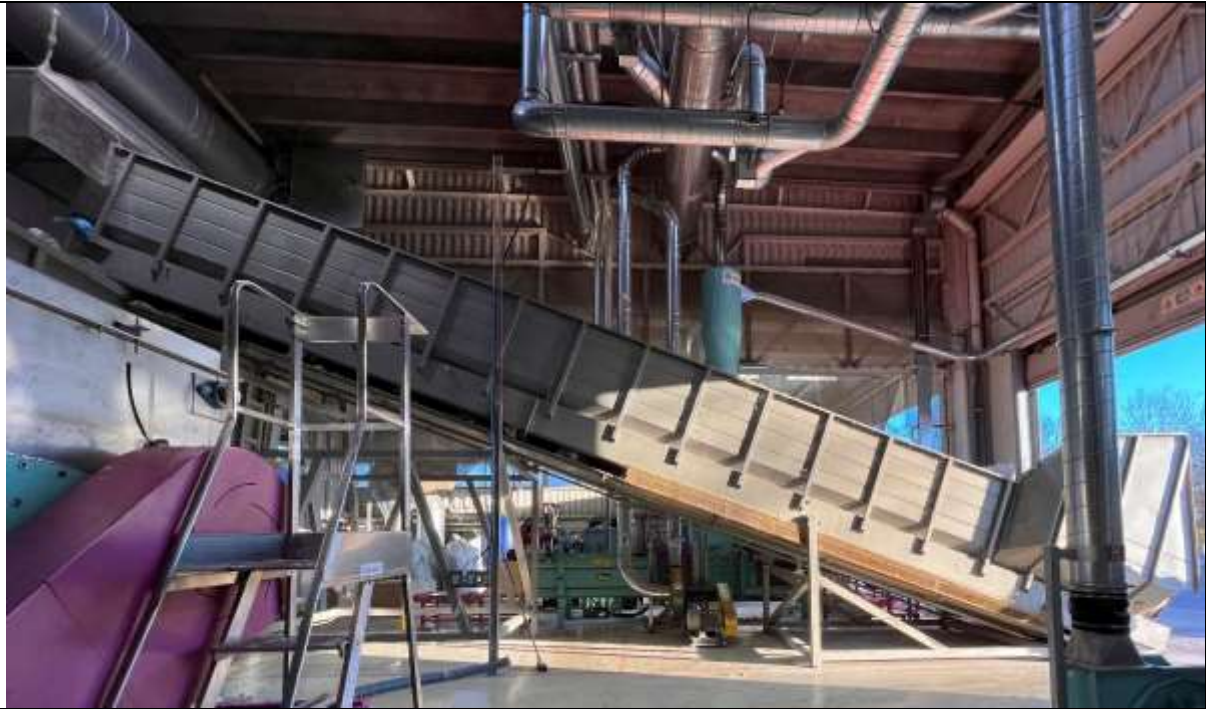
Figura 1 - Trasportatore gommato caricamento Sistema di Accumulo - VISTA
